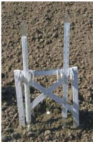
Pomiar temperatury w gruncie
