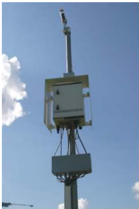
Automatyczna stacja meteorologiczna
