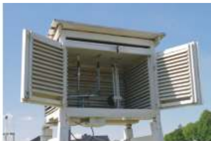
Klatka meteorologiczna z czujnikami temperatury i wilgotności
